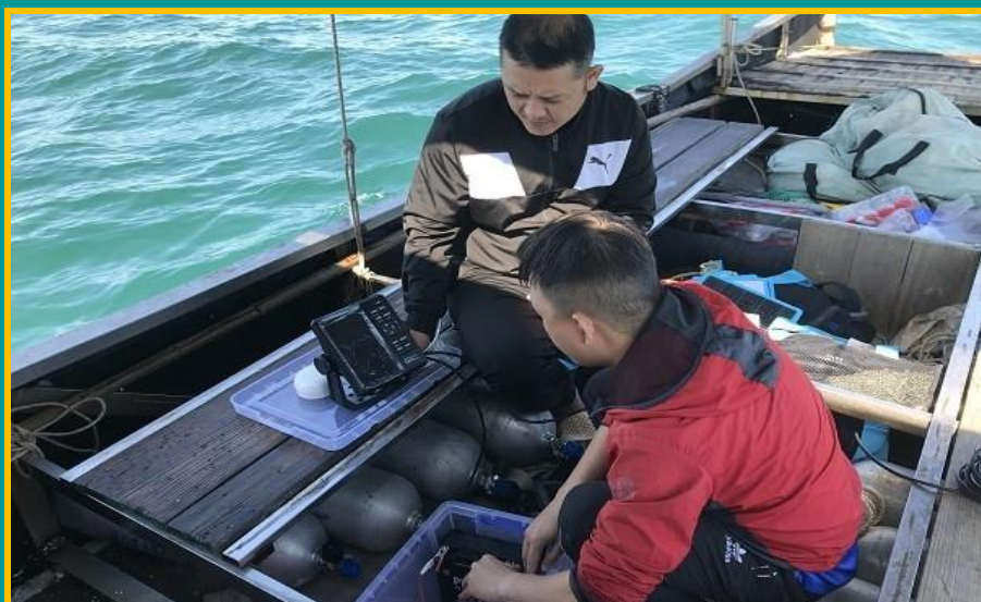
Triển khai đo sâu bằng thiết bị Garmin GPSMAP 585 PLUS tại khu vực bãi cạn, gò đồi ngầm Cô Tô - Thanh Lân
